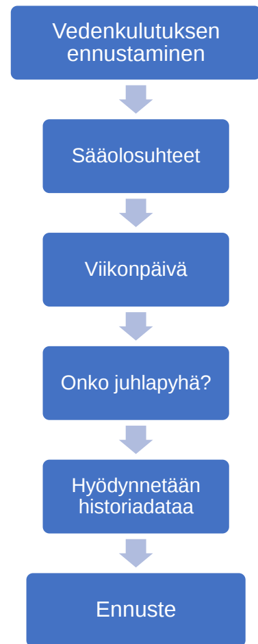
Kuva 6: Vedenkulutusta arvioivan ja ennustavan algoritmin vaiheet yksinkertaistettuna.
